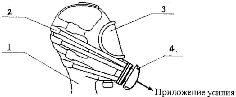
*Рис. 1. Установка для определения прочности соединения в самоспасателе между корпусом кашюона (лицевой части) и ФСЭ:*
