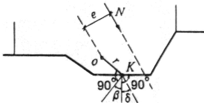
**Рисунок Ж.1 – Схема к определению нормальных и касательных контактных напряжений при ломаной подошве сооружения**
