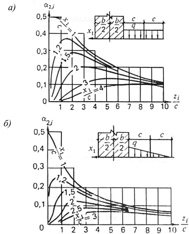
*a* – для прямоугольной пригрузки; *б* – для треугольной пригрузки
