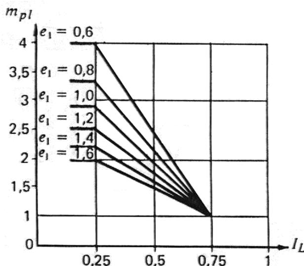
Рисунок В.1 – График для определения коэффициента  $m_{pl}$
