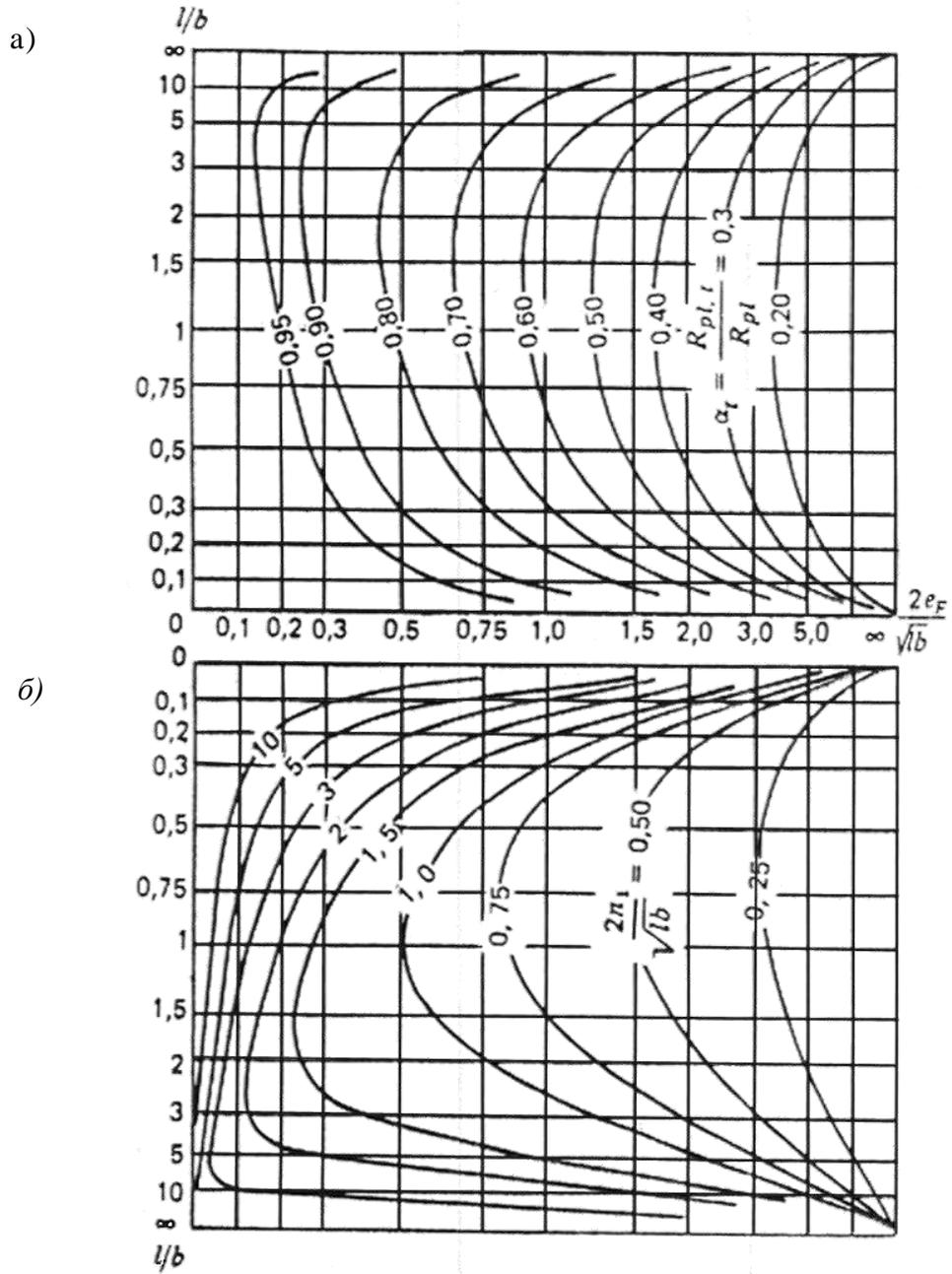
Рисунок Д.2 – Графики для определения коэффициента  $\alpha_t$  (а) и координаты центра поворота  $\pi_1$  (б)
