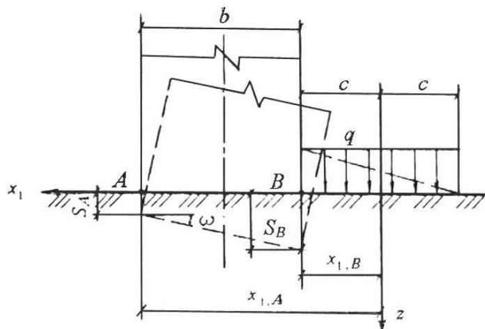
Рисунок 2 – Схема к определению крена сооружения от пригрузки
