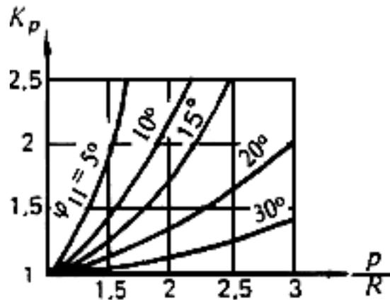
*Рисунок Л.1 – График для определения коэффициента  $K_p$*
