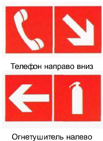
Рисунок 10 - Примеры формирования смысловой комбинации знаков для указания направления движения к эвакуационному выходу, средствам противопожарной защиты, месту сбора и средствам оказания первой медицинской помощи
