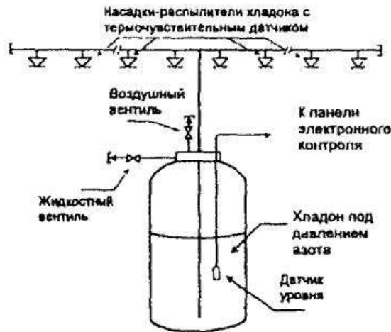
Рис. 9. Принципиальная схема расположения датчиков-распылителей и емкости с хладоном в автономной системе газового тушения пожара в кольцевом зазоре резервуара с плавающей крышей
