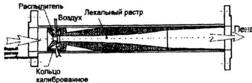
Рис. 2.2. Схема внутреннего устройства пеногенератора
