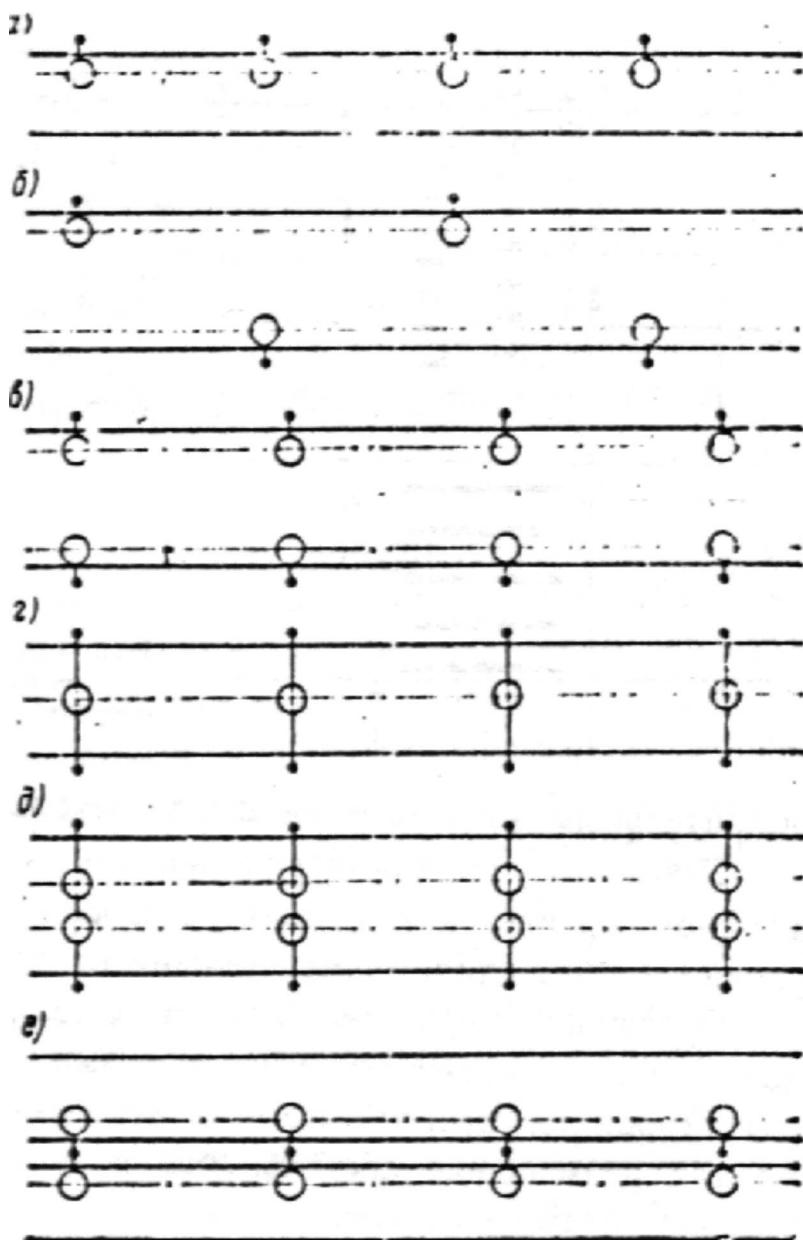
Рис. 1. Схемы размещения светильников в светильниковых установках улиц и дорог
