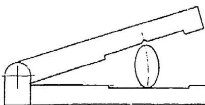
Рисунок 3. Приспособление для оценки хрупкости покрытия рукава
