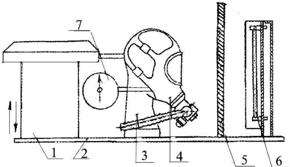
**Рисунок 4. Схема установки по определению устойчивости лицевой части и легочного автомата к воздействию теплового потока:**
