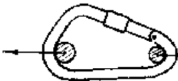
Рис. 2. Схема нагружения карабина вдоль главной оси
