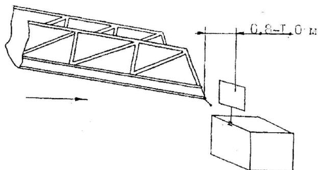
Рисунок 6.1. Движение вершины лестницы за счет сдвигания-выдвижения пакета колен
