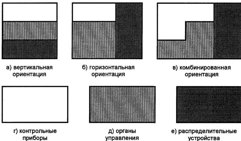
Рисунок 2. Варианты компоновки щитов управления
