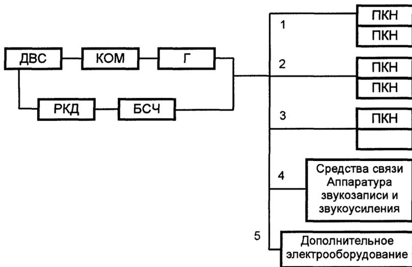
Рисунок 3. Схема разветвления стационарных и переносных приемников электроэнергии АСО:
