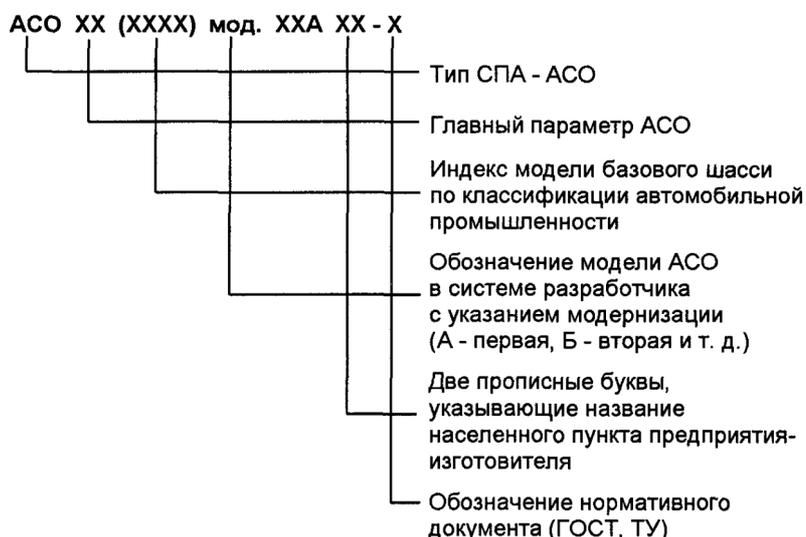
3.2. В качестве главного параметра АСО берется значение мощности основного источника питания (кВт).
