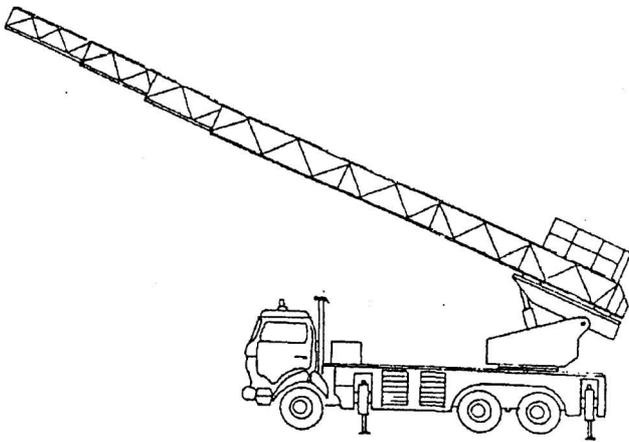
Рисунок 3. Автолестница, оборудованная лифтом, движущимся по лестнице (исполнение 3)
