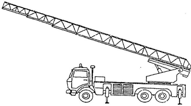
Рисунок 1. Автолестница без дополнительного навесного оборудования (исполнение 1)
