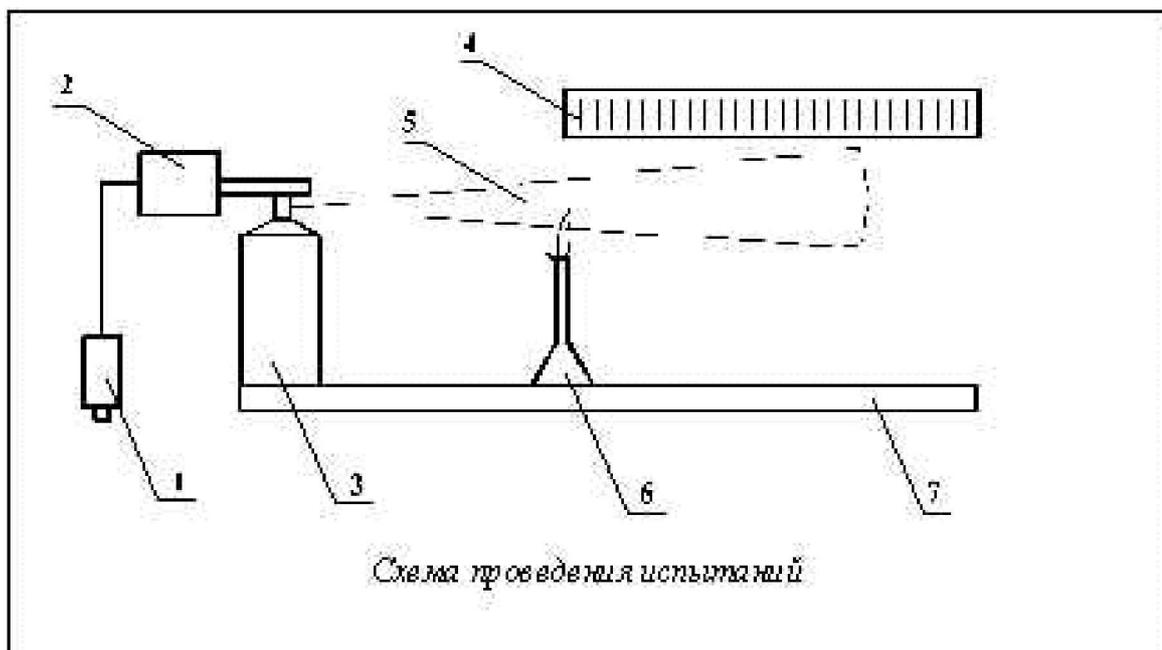
приспособление (7) для крепления аэрозольной упаковки (3) и горелки; горелку (6), например, газовую; устройство для нажатия на клапан аэрозольной упаковки (2); пульт дистанционного управления устройством нажатия (1); измерительную линейку (4) для регистрации значения длины распространения пламени по струе аэрозоля с погрешностью не более  $\pm 0,005$  м.
