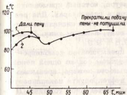
Рис. 9.8. Тушение бензина в резервуаре диаметром 5,3 м воздушно-механической пеной: 1 - температура на поверхности бензина; 2 - температура на глубине 400 мм
