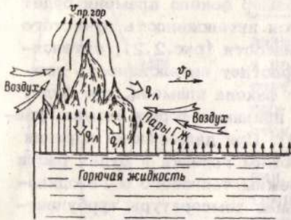
Рис.2.2. Структура диффузионного пламени горючей жидкости
